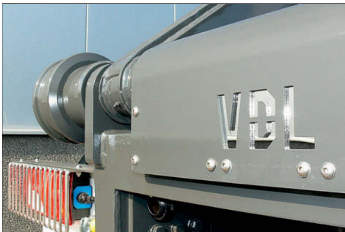
Moderne kabelinstallaties zijn voorzien van een nieuw ontwikkelde differentieel-aandrijving met integrale vergrendeling en een uitgekiende vrijlooppunt
