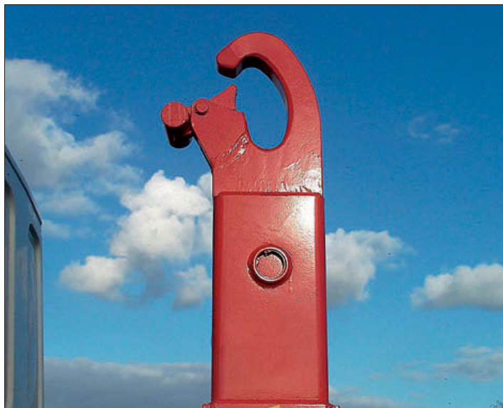
De opneemhaak kan vrij eenvoudig uitgenomen worden, zodat voor verschillende containers gemakkelijk een andere haakhoogte gekozen kan worden
