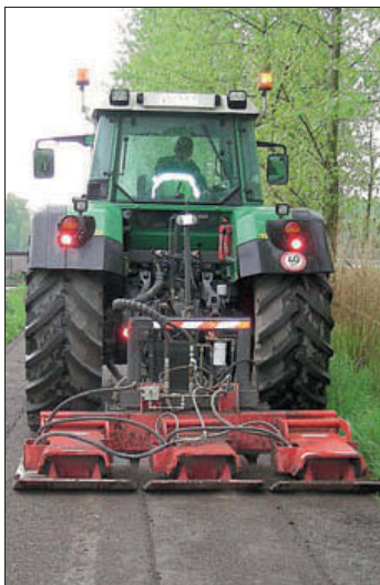
De drie trilplaten leveren elk een slagkracht van 6 ton bij het aantrillen
