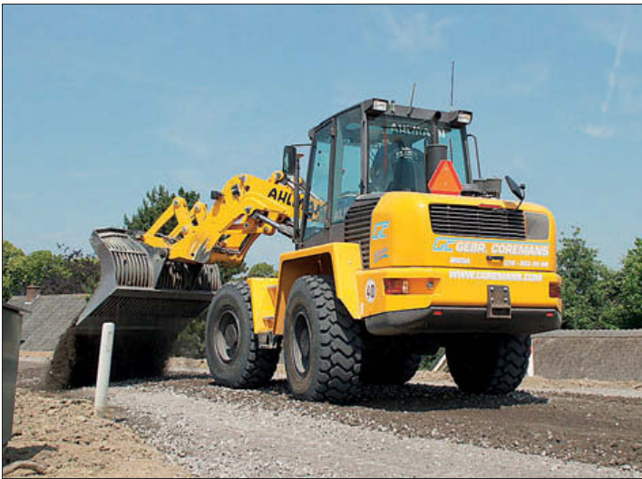
Met een zwenkbare arm kan de bak of een ander uitrustingsstuk zowel 90° naar links als 90° naar rechts gezwenkt worden
