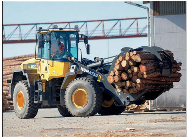
Een houtgrijper voor het snel transporteren van boomstammen of ander houtmateriaal kan ook op een wiellader gemonteerd worden
