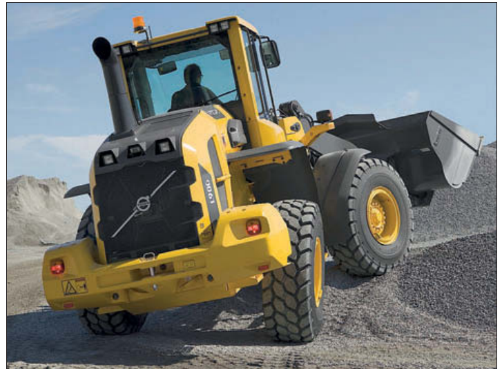
Voor een goede grip bij zowel oneffen als gladde ondergronden zorgt een differentieel met een begrensde slip
