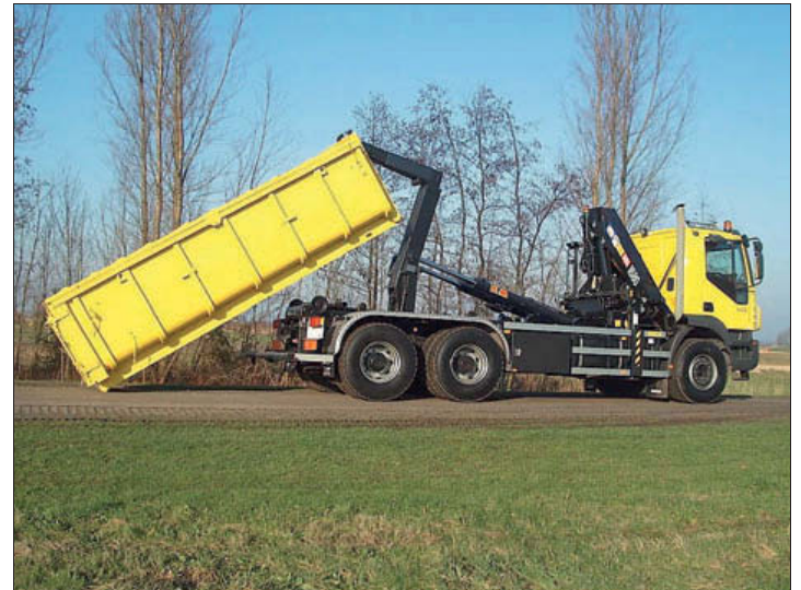
Een goed gebruik van de proportionele besturing zorgt ervoor dat het opnemen van een container in een vloeiende beweging gebeurt
