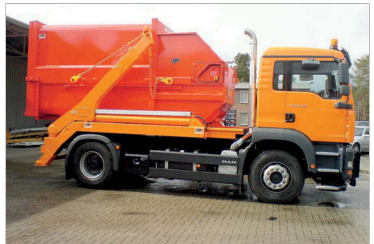
Portaalarmssystemen zijn verkrijgbaar met vaste of met telescopische arm. De speciale knikvorm in de hefarmen draagt bij tot efficiënt manoeuvreren op de kleine ruimte
