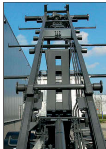
Met lengtes tot 7.200 mm kunnen containers tot 8.000 mm verwerkt worden
